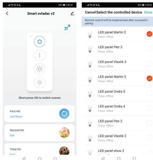
Na jeden ovladač můžete napárovat až 30 světla. Světla musíte s ovladačem párovat po jednom, nelze párovat více světla najednou. Pokud bylo světlo napárováno do aplikace, tak bude tímto postupem z aplikace odebráno!
