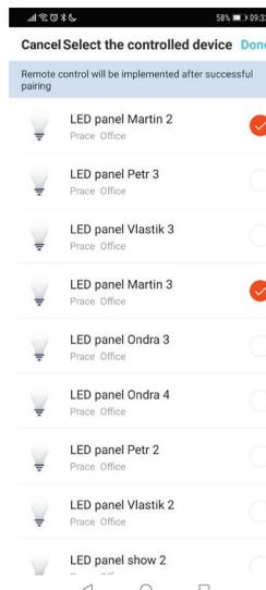
Mit einer Fernbedienung können bis zu 30 Leuchten gekoppelt werden. Die Leuchten müssen mit der Fernbedienung einzeln gekoppelt werden, es können nicht mehrere Leuchten zugleich gekoppelt werden.
